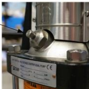
Рис. 4 Пробка на насосе для выпуска воздуха.
