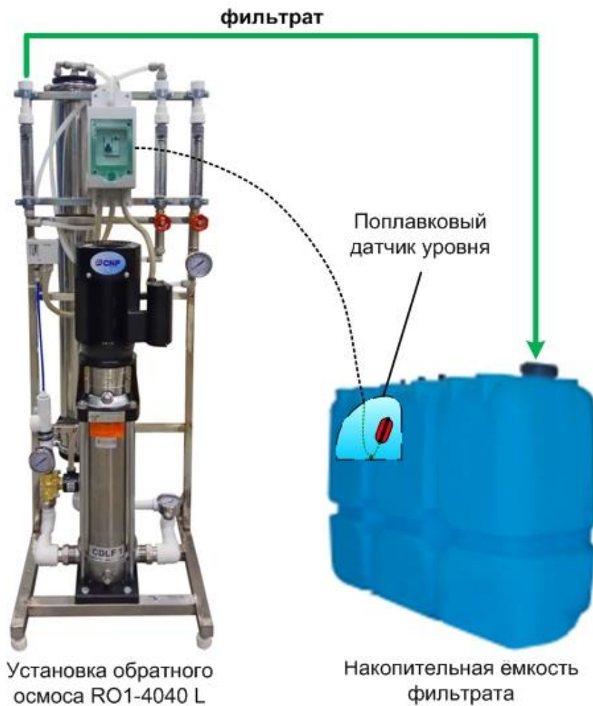
Рис. 4. Подключение датчика уровня к установке.
